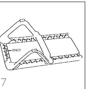
Termine el ensartado del travesaño inferior de la tumbona. Tire y extienda ambos extremos del cordón. Haga un nudo en ambos extremos junto a los agujeros que se hallan cerca del centro del travesaño inferior de la estructura de la tumbona.
