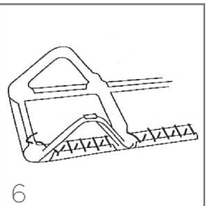
Continúe encordando ambos lados de la parte inferior de la tumbona. Tire y extienda ambos lados del cordón en cuanto llegue a las esquinas inferiores de la tumbona.
