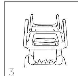
Continúe encordando la tela simultáneamente a ambos lados del travesaño. Al llegar a las esquinas de la parte superior del respaldo, tire y extienda ambos extremos del cordón a cada lado de la tumbona.
